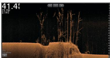
传统换能器会发出锥形波束。Garmin ClearVü 扫描声纳技术会发出与复印机中光束形状相似的两道窄波束。这些波束可提供船只底下物体的更清晰的图片式图像。
