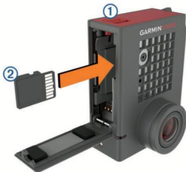
2 将存储卡 ② 插入卡槽, 将存储卡按到底直到发出咔嚓声。
